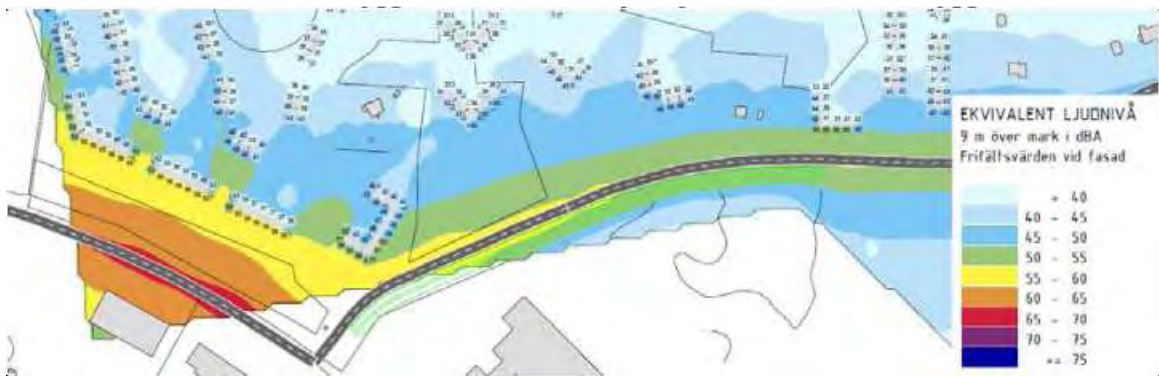
Utdrag ur bullerutredning Hagavik avseende trafikbullers spridning. Gul färg symboliserar 55-60 dBA dygnsekvivalenta nivåer.
